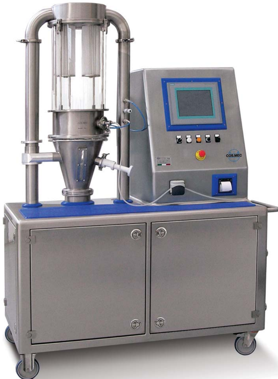
Contenitore mobile e ribaltabile per scarico prodotto Movable and inverting container for discharging product
