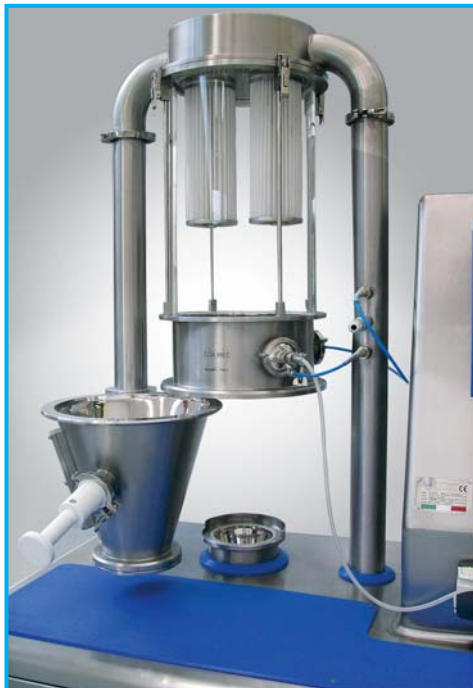
Contenitore mobile e ribaltabile per scarico prodotto Movable and inverting container for discharging product
