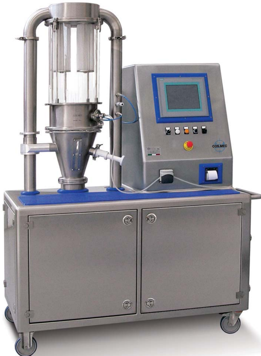
Contenitore mobile e ribaltabile per scarico prodotto Mobile, tiltable container for product discharge
