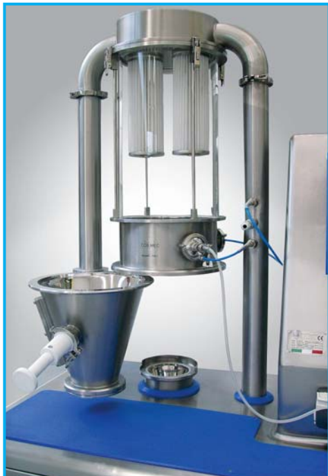
Contenitore mobile e ribaltabile per scarico prodotto Mobile, tiltable container for product discharge
