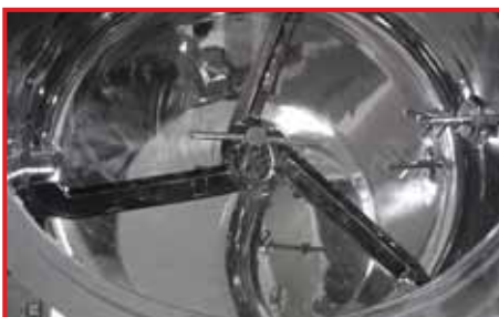
Pala di miscelazione e granulazione a 3 razze Mixing and granulating blade with 3 coilers
