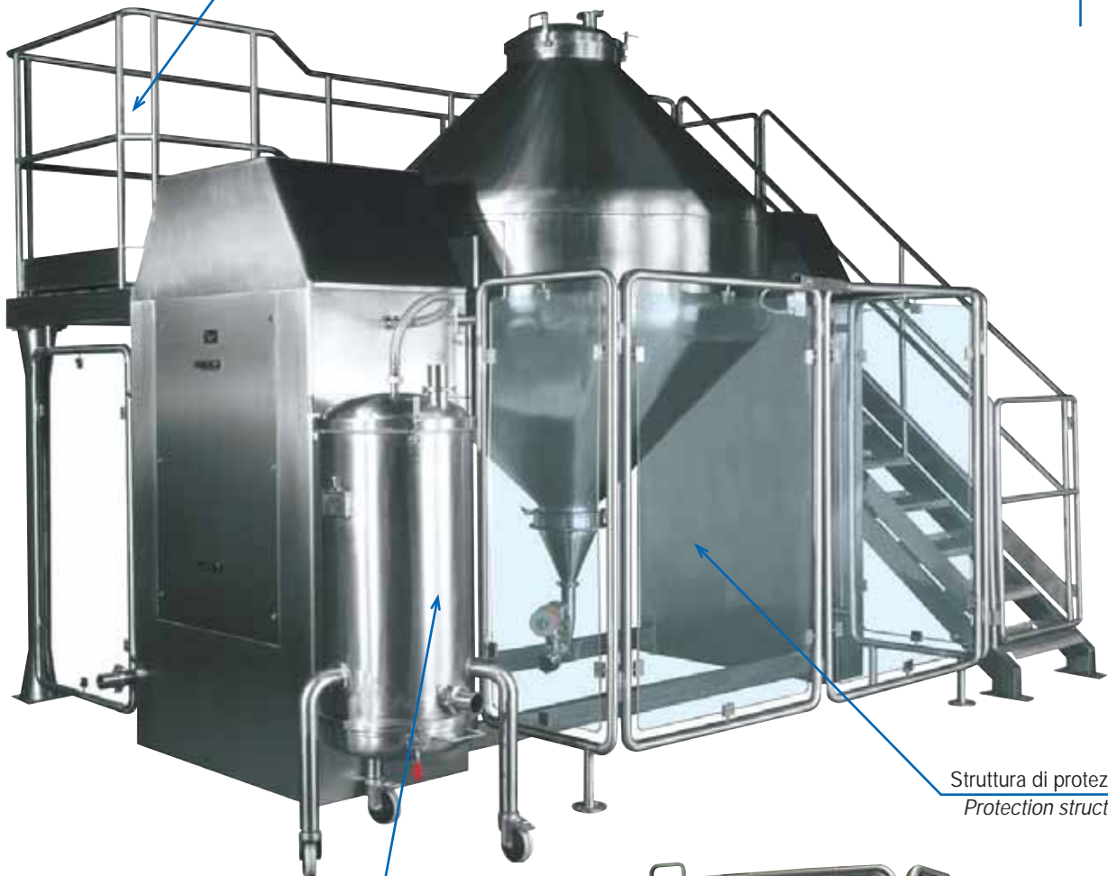
Pedana d'ispezione per macchine di grande volume Inspection platform for machines of big volume
