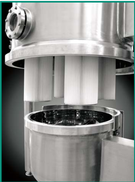
Posizionamento per smontaggio dei filtri a cartuccia Positioning for cartridge filters disassembling
