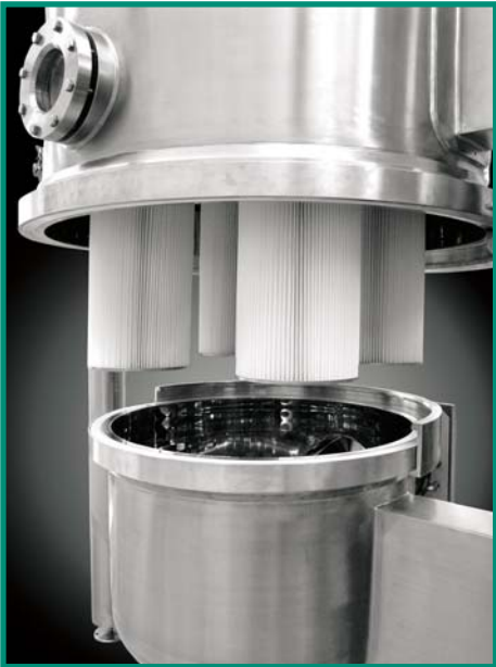
Posizionamento per smontaggio del filtro a cartuccia Positioning for cartridge filters disassembling
